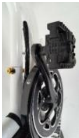
Detailbild 1: eingeklappte Pedale
