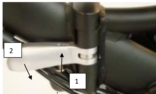
Detailbild 2: Verschlusstyp 2 (fixierter Zustand)
