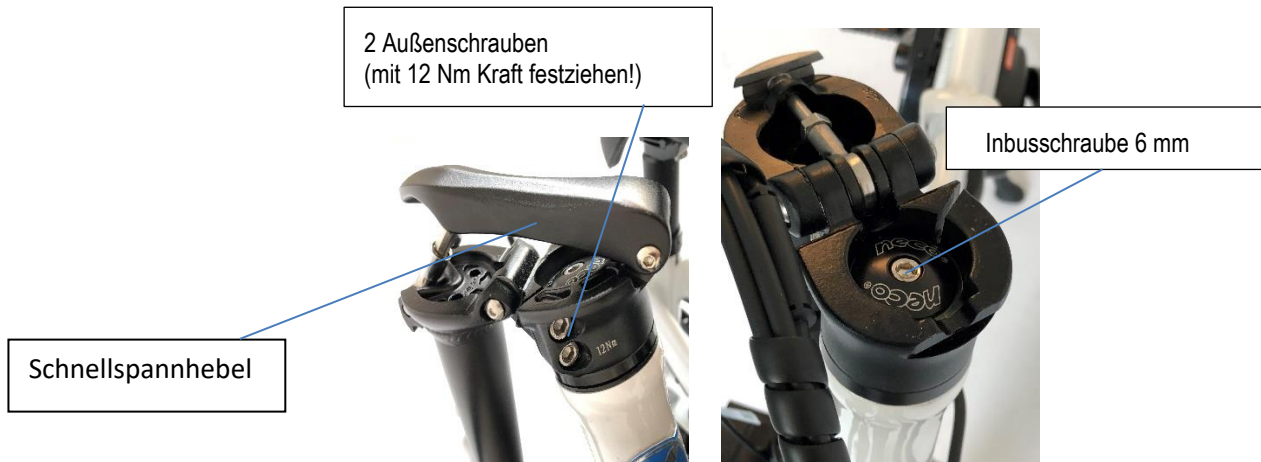
Detailbild 3: geöffnetes Gelenk des Lenker-Vorbau
