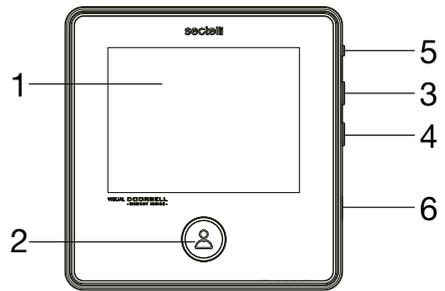
**6. Wählen der Ausschaltzeit:** Drücken Sie bei eingeschaltetem Display die Unten-Taste 3 Sekunden lang, um die Ausschaltzeit auszuwählen: 15s / 25s / off
