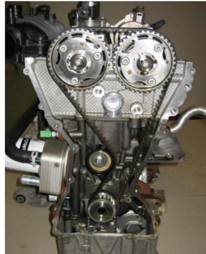
Eines der Werkzeuge (1) auf der Einlassnockenwelle und das andere (1) an der Auslassnockenwelle lose positionieren. Die Arretierschrauben der Nockenwellen-Werkzeuge nur handfest anziehen und dabei sicherstellen, dass die Nockenwellen-Werkzeuge richtig auf den Nockenwellen positioniert sind. Die Nockenwellen-Werkzeuge durch Anziehen der 8 Haltebolzen auf 10 Nm auf dem Zylinderkopf arretieren.
