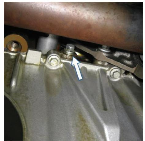
Werkzeug (3) anbringen und sicherstellen, dass er vollständig im Motorblock platziert ist.
