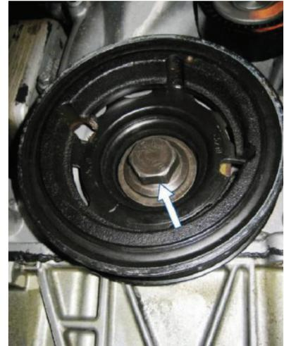
Die Kurbelwellen-Riemenscheibe ausbauen und die Kurbelwellen-Öldichtung von der Steuerriemen-Abdeckung entfernen und dabei darauf achten, dass die Dichtfläche der Abdeckung nicht beschädigt wird.
