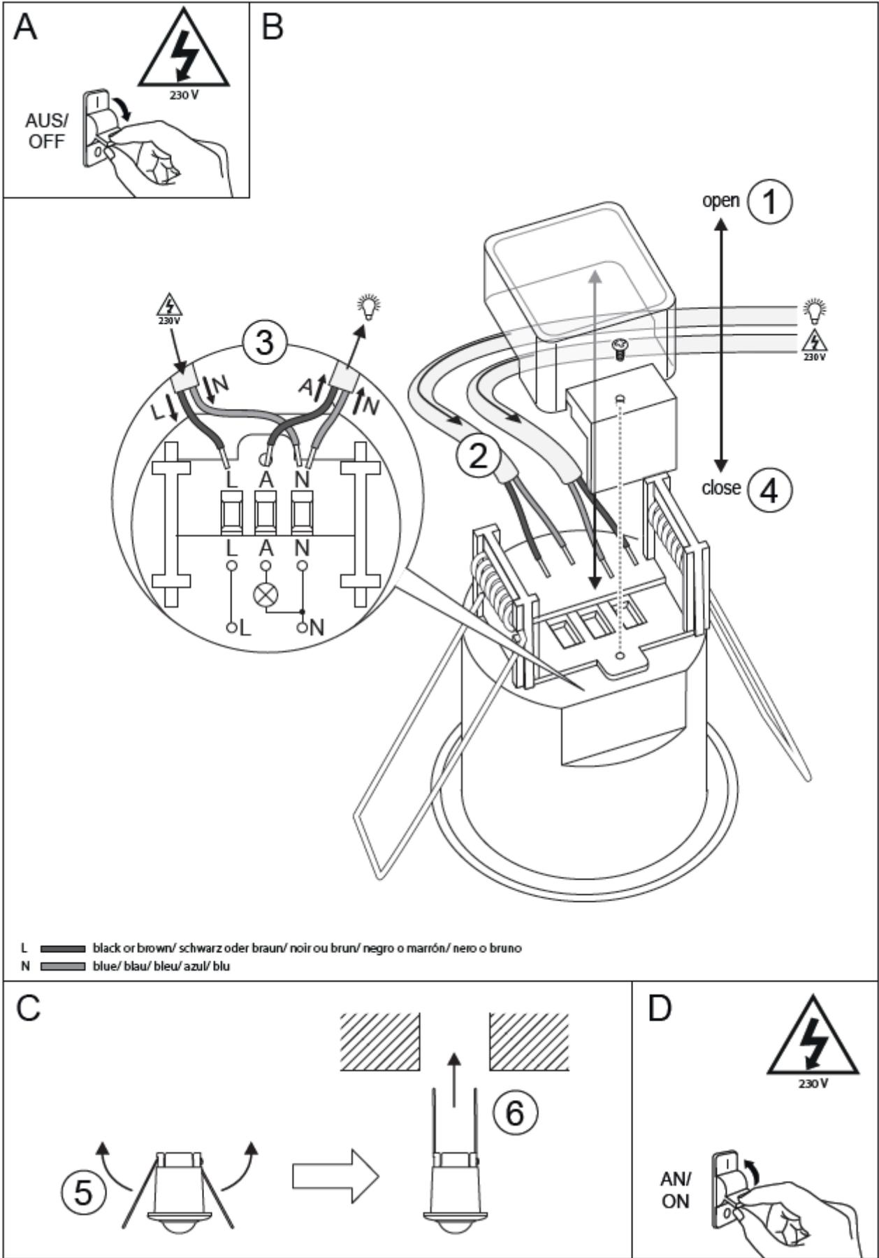
**Function of the movement/ Funktion des Bewegungsmelders/ Fonction du détecteur de mouvement/ Función del detector de movimientos / Funzione del rivelatore di movimento:**
