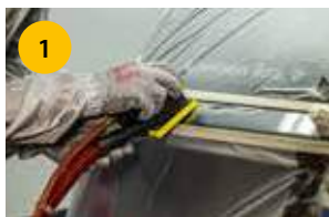
1 Lack entfernen und Übergänge schleifen OSP-2, OSP-3
