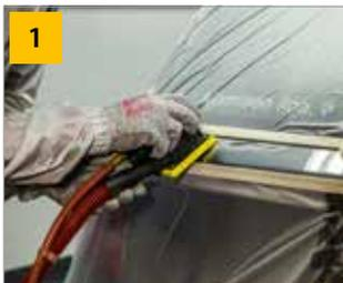
Lack entfernen und Übergänge schleifen
