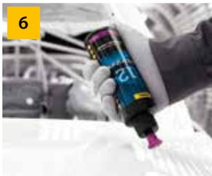
6 Tragen Sie eine kleine Menge Polarshine® 20 auf das Polierpad oder direkt auf die zu bearbeitende Oberfläche auf.
