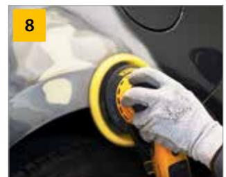
8 Verwenden Sie zum Anschliff der Auslaufzone Iridium K 320 und Mirka DEROS 650CV.
