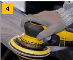
Verwenden Sie Iridium K 800 - K 1000, die Softauflage, sowie den Mirka DEROS zum Vorschleifen der Einlackierzone.
