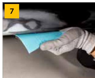
7 Schleifen Sie mit Novastar Flex K 400 die Ecken und Kanten vor.
