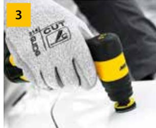
3 Üben Sie leichten Druck mit der Schleifmaschine aus und halten Sie die Position für 2-3 Sekunden.
