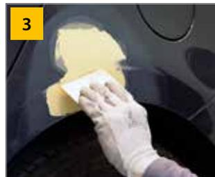
3 Reinigen Sie die Reparaturfläche und tragen Sie den Spachtel auf.
