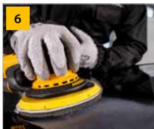
Nutzen Sie Mirlon UF 1500, Abralon J5 K 1000 und den Mirka DEROS für den finalen Perfektschleif.
