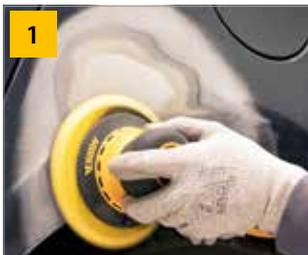
1 Nehmen Sie Iridium K 120 - K 150 und den Mirka DEROS, um die Reparaturfläche blank zu schleifen.
