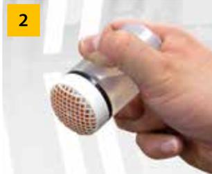
2 Verwenden Sie immer Wasser beim Schleifen. Tragen Sie dies auf Schleifmittel und die zu bearbeitende Stelle auf - für das bestmögliche Ergebnis.
