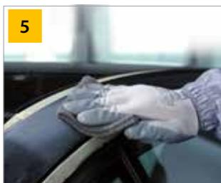
Schleifen Sie die Ecken und Kanten mit der Kombination aus Novastar Flex K 800 und Mirlon Total XF 800.
