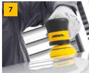
7 Polieren Sie mit leichtem Druck und nutzen Sie eine moderate Geschwindigkeit. Prüfen Sie die Oberfläche und falls notwendig, wiederholen Sie den Schritt.
