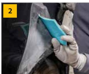
Schleifen Sie Ecken und Kanten mit Novastar Flex K 600 und K 800.
