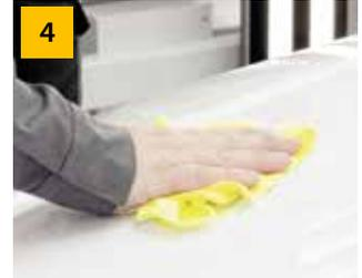
4 Nutzen Sie zum Trocknen das Mirka Mikrofaser Tuch. Prüfen Sie die Oberfläche und falls notwendig, wiederholen Sie Schritt 3.
