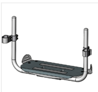
// QSF050061 Fußbrett, durchgehend, Leichtgewicht, Kunststoff, winkel- / tiefeinstellbar, hochklappbar (seitlich), hochmontiert, Wadenband, schwarz
