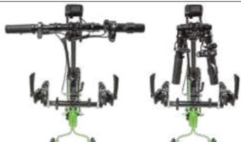
Doppeltes Bremssystem (Trommel- und elektronische Bremse)
