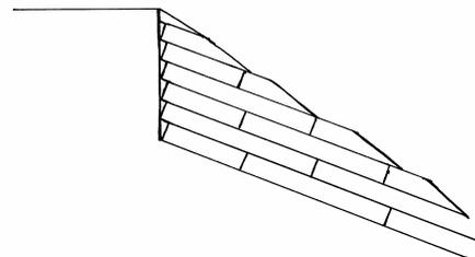
Die einzelnen Schichten können auch um jeweils eine Öffnung nach hinten verschoben werden, so dass nur die obere Schicht winkelförmig zugeschnitten werden muss.
