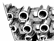
Nun werden die Fliesen bzw. Rampen über den Haltestiften so abgelegt, dass sich letztere zwischen den Röhrenschächten der Fliesen befinden. Die Fliesen bzw. Rampen können so nicht verrutschen und lassen sich zu Reinigungszwecken leicht hochnehmen.
