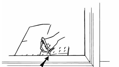
Ermitteln Sie die korrekte Höhe, indem Sie wie hier dargestellt eine Rampenseite gegen die Türschwelle hochhalten, und markieren Sie die korrekte Rampenhöhe.
