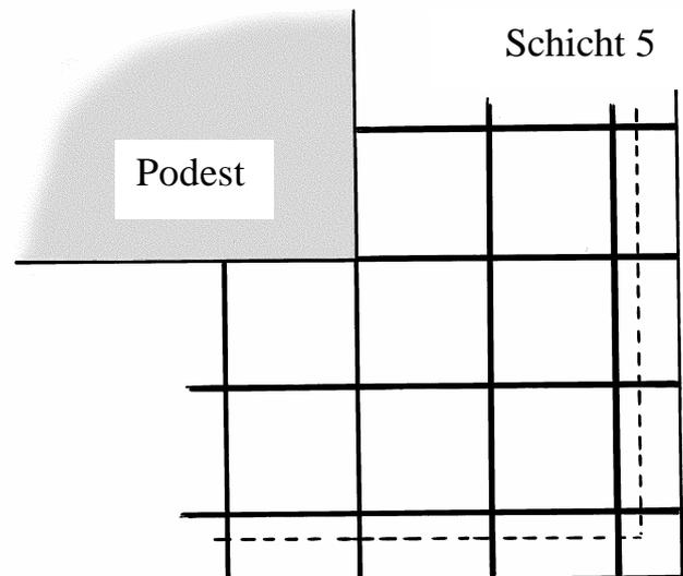
Wie der Zeichnung von Schicht 5 zu entnehmen ist, ist die Eckrampe selbst quadratisch, da sie aus 2 x 2 Fliesen + Rampe besteht
