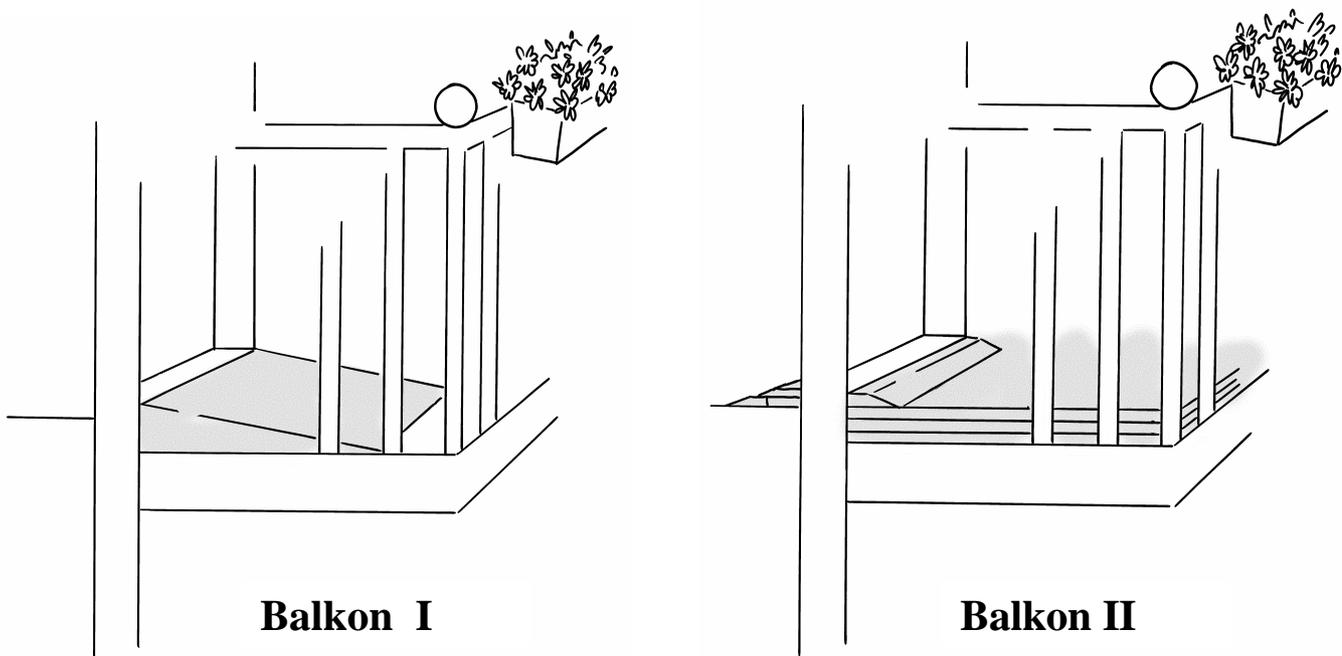
Bei Balkon I ist ausschließlich eine Rampenlösung zur Anwendung gekommen. Das Benutzen des Balkons durch die betreffende Person ist hier praktisch unmöglich, da das Hinausgelangen auf den Balkon mit einem Fahrstuhl oder einem Gehwagen, ohne in das Geländer hineinzufahren, unmöglich ist. Der Benutzer muss bei dieser Lösung darauf vorbereitet sein, nur in der Anwesenheit eines Helfers hinausgelangen zu können.
