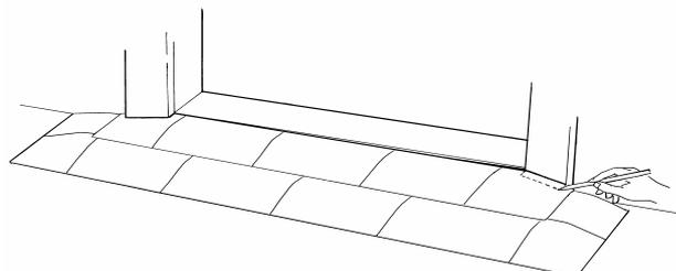
Markieren Sie und sägen Sie jetzt bei Bedarf den Türrahmen zurecht.
