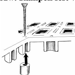
Die Rohrmutter Nr. 12520 wird in den Röhrenschacht der Fliese eingesetzt und mit der von der anderen Seite hindurchgesteckten Schraube Nr. 12531 am Boden befestigt, so dass die Fliese unverrückbar fest sitzt.
