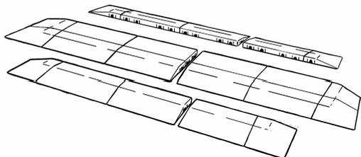
Fangen Sie mit dem Zusammensetzen der einzelnen Einheiten an. Benutzen Sie dabei den Gummihammer aus dem **TCR Montagekoffer**, Artikel Nr. 12725.
