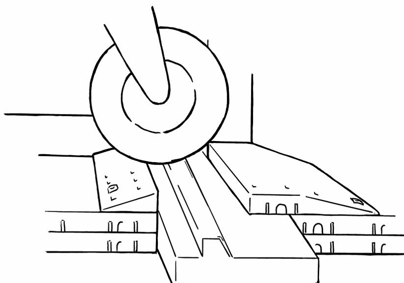
Jetzt können sowohl Rollstühle als auch Gehwagen problemlos die Schiene passieren, es ist nur ein kleiner Aufprall wie beim Passieren eines Autos über einen Bahnübergang wahrnehmbar.
