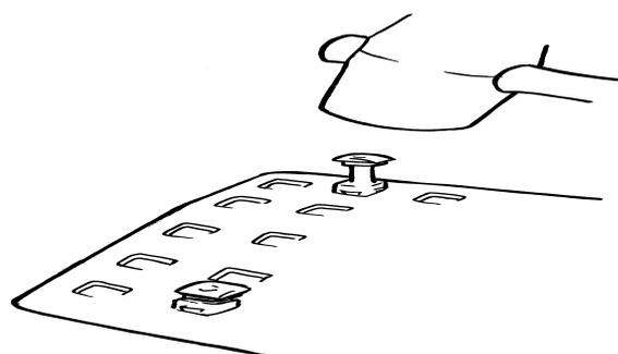
Schlagen Sie jetzt die **T-Locks** und **R-Locks** mit Hilfe des Gummihammers in die Rampe hinein und sichern Sie dadurch die beiden Schichten.
