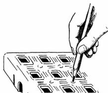
Beginnen Sie die Arbeit, indem Sie die entsprechenden Stellen über den Röhrenschächten oben anzeichnen. Nun wird die Fliese so durchbohrt, dass man in den Röhrenschacht stößt, dann bohrt man durch diesen hindurch ein Loch in den Boden.
