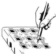
Beginnen Sie die Arbeit, indem Sie die entsprechenden Stellen über den Röhrenschächten oben anzeichnen. Nun wird die Fliese so durchbohrt, dass man in den Röhrenschacht stößt, dann bohrt man durch diesen hindurch ein Loch in den Boden.
