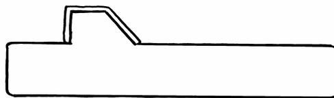
Sowohl diese als auch andere Schientypen, die in Verbindung mit Türen und Pforten verwendet werden, neigen oft dazu, Rollstuhlfahrern und Benutzern von Gehwagen Probleme zu bereiten. Falls die Tür mit besonderen „Fahrplatten“ angeliefert wird, müssen diese vor einer Schließung der Türen hinausgelegt und wieder entfernt werden.
