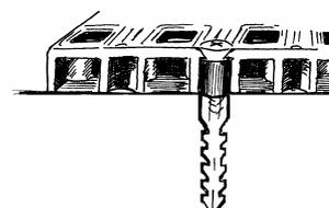
Beachten Sie bitte, dass bei dieser Art der Befestigung die Schraube vor dem Hochnehmen der Fliese erst herausgedreht werden muss.
