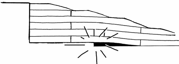
Der hier gezeigte Höhenunterschied, der von der Rampe überbrückt wird, führt im Laufe der Zeit dazu, dass die darüber liegenden Fliesen brechen. Fliesen mit solchen Brüchen fallen nicht unter die Garantie!
