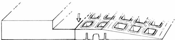
Drehen Sie nun die Rampe um und senken Sie diese über die Schraubenköpfe ab. Damit sitzt sie an der Türschwelle fest, kann aber jederzeit wieder angehoben werden.
