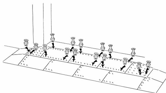
Beachten Sie dabei bitte, dass **T-Locks** immer auf horizontalen Flächen verwendet werden, während **R-Locks** immer für die Reihe von **schrägen** Löchern unten an der Rampe oder an der Eckrampe benutzt werden.
