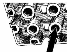
Nun wird der Röhrenschacht der Fliese bzw. der Rampe auf den Haltestift gesetzt und angedrückt. Auf diese Weise erreicht man einen sicheren Sitz und kann bei der Reinigung die Teile leicht hochnehmen.
