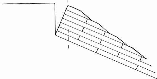
Die Rampe wird normal zusammengebaut und anschließend in einem passenden Winkel mit der Säge zugeschnitten.
