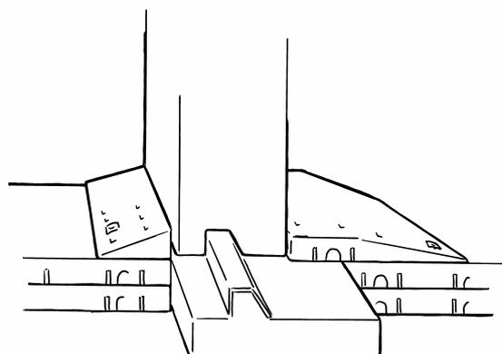
Es ist von besonderer Wichtigkeit, eine Anpassung der Höhe der beiden Rampen vorzunehmen, so dass sie der Höhe der zu passierenden Schiene entsprechen. Für Informationen zur Anpassung der Rampenhöhe sehen Sie bitte die Rückseite.
