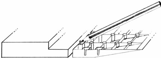
Bauen Sie die Rampe zusammen, wobei diese umzudrehen ist. Rücken Sie diese ganz an die Türschwelle heran und bringen Sie eine Markierung zu beiden Seiten an – dort, wo sich die Schrauben befinden sollen. Benutzen Sie dabei die hinten an der Rampe befindlichen Schlitzte zum Anzeichnen der Schraubenpositionen.
