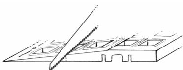
Sägen Sie – unter Verwendung der im **TCR-Montagekoffer** mitgelieferten Spezialsäge, Artikel Nr. 12725 – an der schrägen Seite der Rampe bis die korrekte Höhe ermittelt worden ist.
