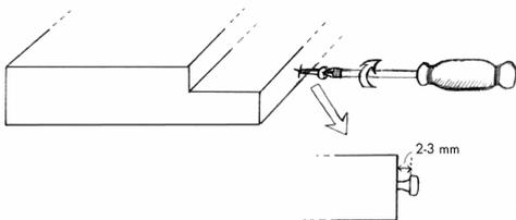
Die „Schrauben für die Rampenbefestigung an der Türschwelle“, Art.-Nr. 12540 des Montagesetts verwenden. Zum Anziehen der Schrauben benutzen Sie bitte den „Schraubenzieher PZ2“, Art.-Nr. 12575, der sich ebenfalls im Montagesettt befindet.
