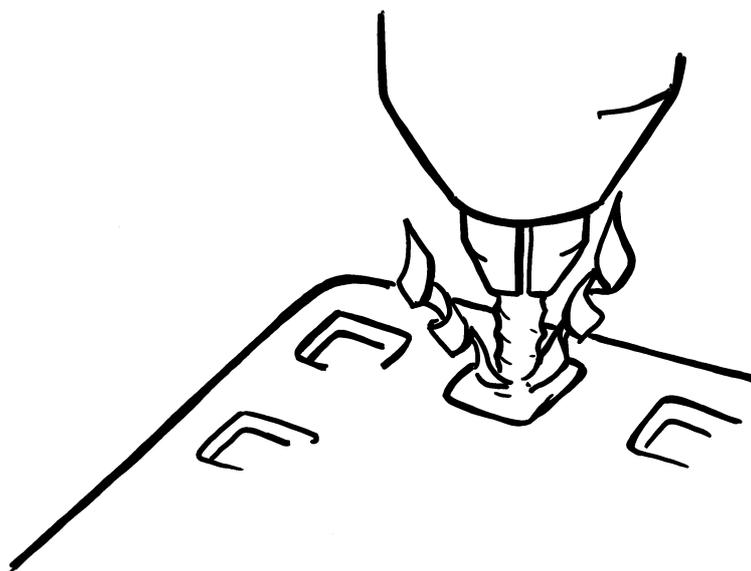
Zum Aufbohren der Steckverbindung ist ein 6 oder 8 mm Bohrer zu verwenden.
