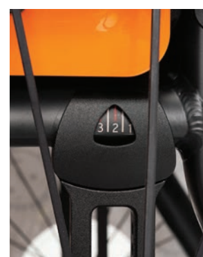
Die Hinterräder können in 8 verschiedenen Positionen vorwärts oder rückwärts verstellt werden.
