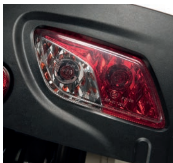
Beleuchtung und Reflektoren
