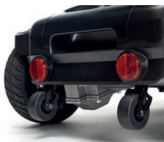
Anti-Kipp-Räder für zusätzliche Sicherheit
