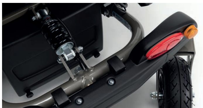
Die Pendelachse sichert die Fahrstabilität
