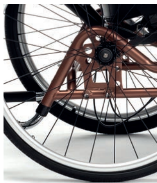
Einstellbare Sitzhöhe ohne Veränderung der Radposition
