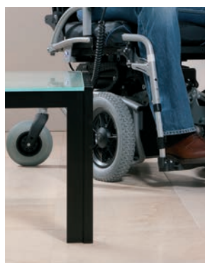
Gegenläufige Drehbewegung der Antriebsräder vorne ermöglicht das Wenden mit geringem Wendekreis.
