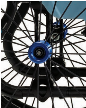
Abnehmbare Hinterräder für einfachen Transport
