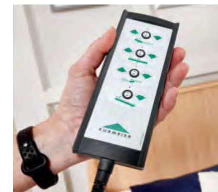
Handschalter • mit selektiver Sperrung
