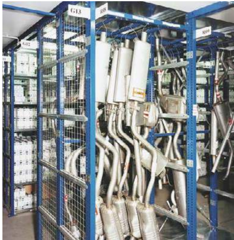
Fachbodenregal für die hängende Lagerung von Schalldämpfern. Branche: KFZ-Teilehandel
