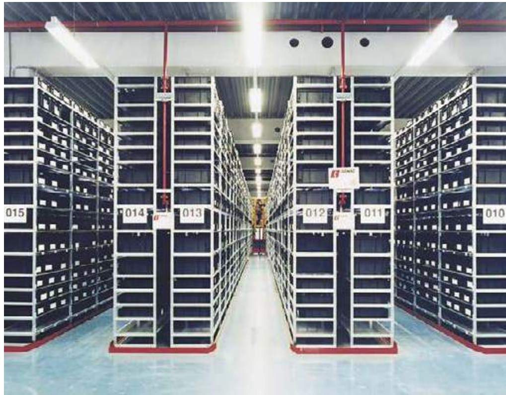
Fachbodenregalanlage für ein ESD-Lager, komplett verzinkt.
