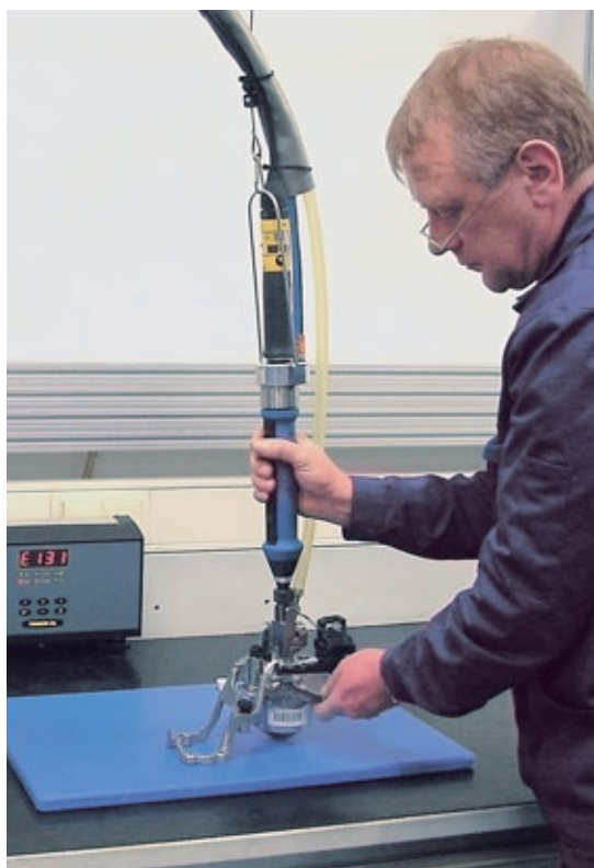
Handschrauber mit Elektroantrieb Hand-held screwdriver with electrical drive
