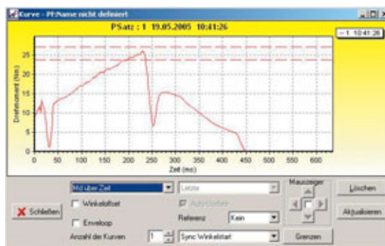
PC gestützte Programmierung und Analyse von Elektroschraubern PC controlled programming and analysis of electric-power fastening process
