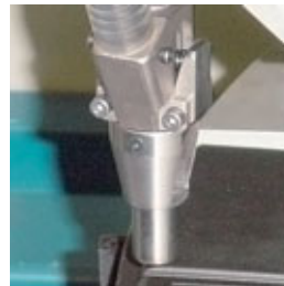
Mundstück mit Führungshülse Nozzle with guide bush
