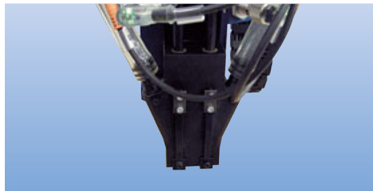
Kompaktes 2-fach Mundstück / Compact 2-fold nozzle
