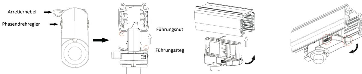
1. Vergewissern Sie sich vor der Installation, dass die Positionen des Schienenadapters mit denen in der Abbildung übereinstimmen.
