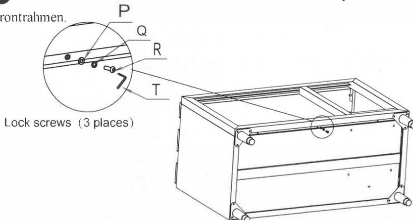
6 Montieren Sie die Feststellschrauben zwischen Grundplatte und Rückplatte.
