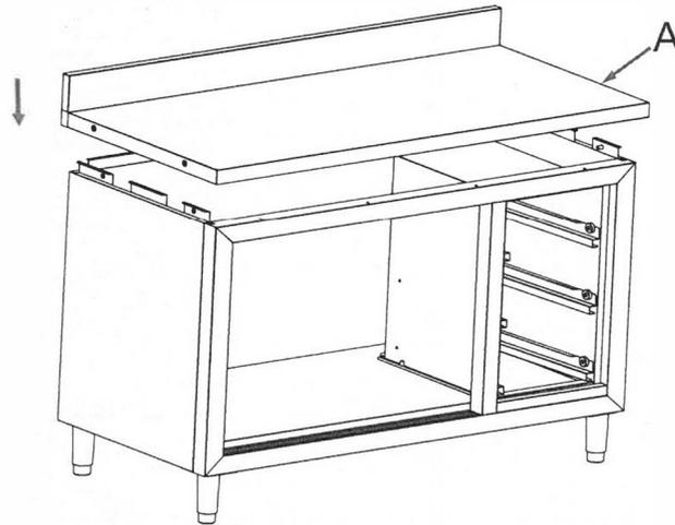
10 Feststellschrauben zwischen Tischplatte und beiden Seitenplatten montieren. 4x
