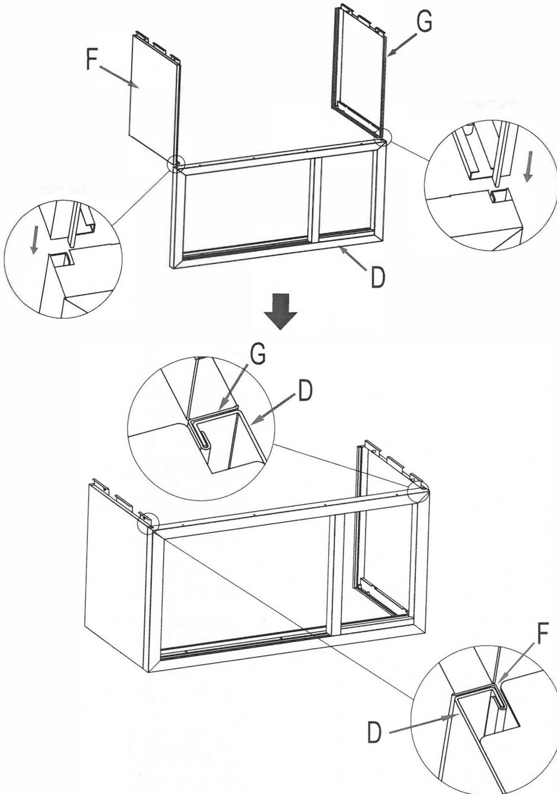
2 Montieren Sie die Rückwand in den Kerben der Seitenplatte.
