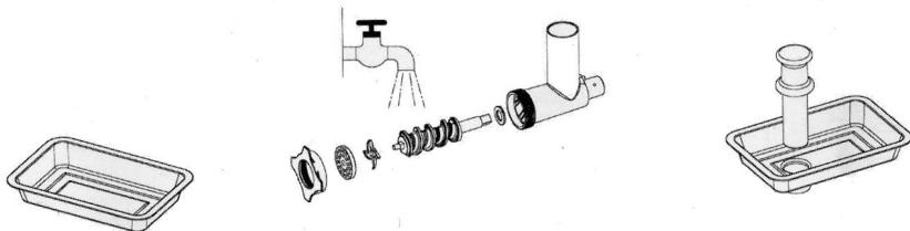
Nach der Reinigung und Trocknung, benetzen Sie die Teile, welche mit den Lebensmitteln in Berührung kommen mit etwas Speiseöl.
