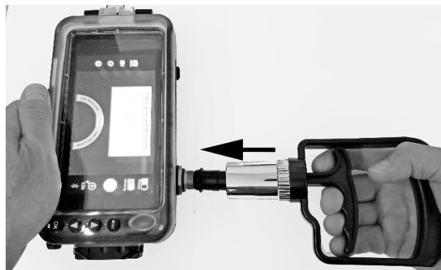
Handpumpe gegen den Vakuum-Checkport drücken
