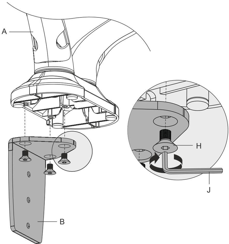
Variante 1: Bei Tischplattendicke: min. 10mm - max. 55mm
