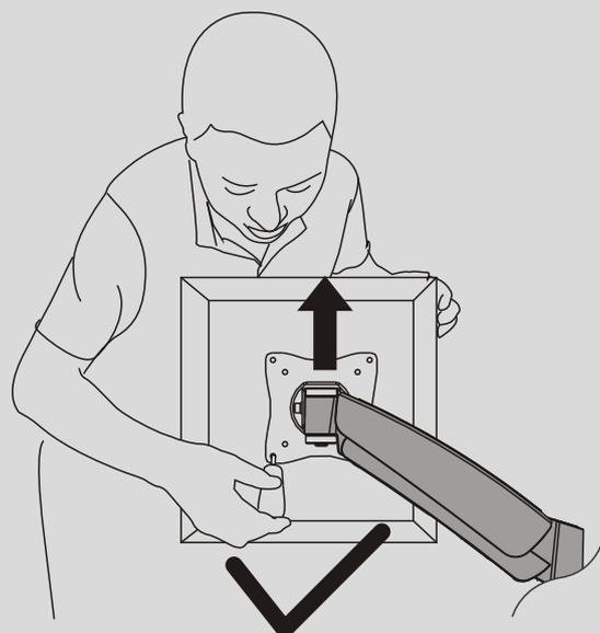
**Achtung:** Der Arm kann aufgrund der Gasdruckfeder nach oben schnellen!
