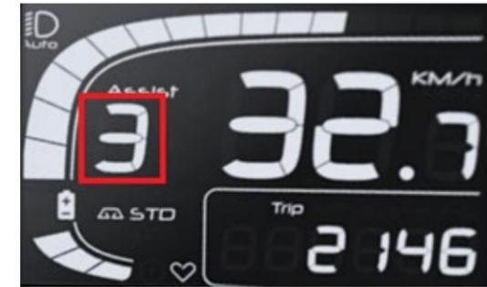
Wenn das Steuerdisplay eingeschaltet wird, ist die Geschwindigkeitsstufe 0. Es gibt 5 Geschwindigkeitsstufen. Auf Stufe 0 fährt das E-Bike ohne Geschwindigkeitsunterstützung. Mit der Mindestleistungsstufe 1 beginnt die Fahrerunterstützung und die maximale Leistung erhalten Sie auf Stufe 5. Sie können die Geschwindigkeitsstufe über die ^- und V-Taste wechseln.
