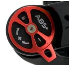
Auf der Oberseite der Federgabel befindet sich der Drehknopf für die Druckstufendämpfung. Mit Hilfe des Drehknopfes können Sie die Federung weicher und härter stellen, oder diese ganz blockieren.
