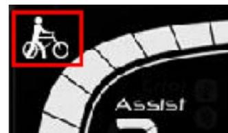
Um die Funktion zu aktivieren, halten Sie die V-Taste gedrückt. Nach 2 Sekunden fährt das E-Bike in Schrittgeschwindigkeit (6 km/h) weiter. Die Funktion wird ausgeschaltet, sobald die V-Taste nicht mehr gedrückt wird. Dieser Modus funktioniert nur, indem die V-Taste gedrückt bleibt.
