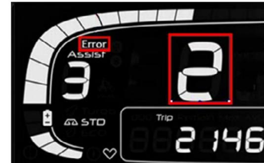
Die Komponenten des E-Bike-Systems werden kontinuierlich und automatisch überwacht. Sobald ein Fehler erkannt wird, zeigt Ihnen das Steuerdisplay einen Fehlercode an: (Index der Fehlermeldungen)
