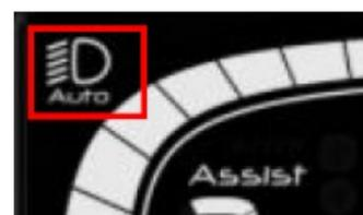
Bei eingeschalteten Display klicken Sie kurz auf die Ein/Aus-Taste um das Licht einzuschalten. Es wird das Lichtsymbol auf dem Display angezeigt. Klicken Sie dann erneut auf die Ein/Aus-Taste, wird das Licht ausgeschaltet.
