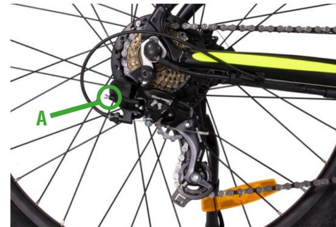
Nach einer gewissen Nutzungsdauer oder der Erstmontage Ihres E-Bikes ist die Kette nicht korrekt justiert oder möglicherweise aufgrund der Übertragungsstärke abgenutzt. Die Kette kann durch eine Spannschraube, die die Kette festhält, richtig eingestellt werden. Die Kette sollte auf dem kleinsten Zahn des Schwungrades eingestellt sein. Drehen Sie die hintere Getriebespannschraube (A). Die Kette sollte nicht durchhängen. Achten Sie auch auf genügende Fettung der Kette und deren Sauberkeit.
