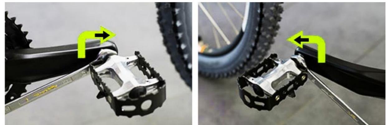
4. Verwenden Sie einen 15-mm-Maulschlüssel, um den Fuß zu verriegeln.
