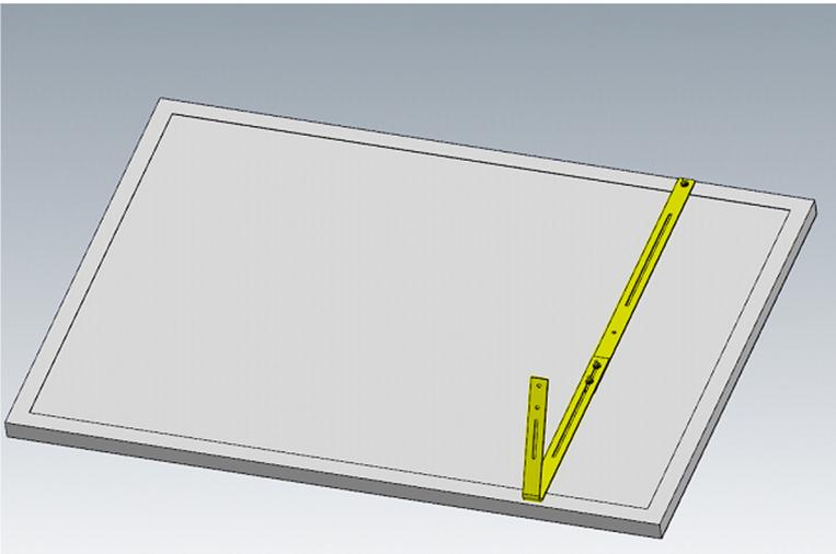
4. Befestigen Sie jetzt den 30°-Bogen, indem Sie diesen am oberen Ende des Schlitzes im geraden Stab festschrauben.
