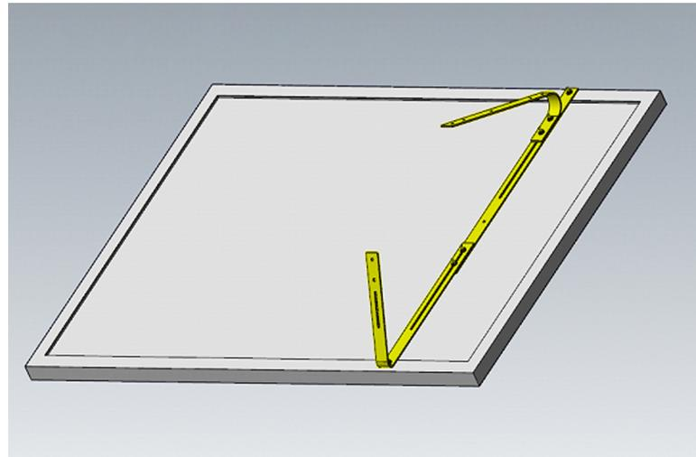
5. Setzen Sie den 90°-Winkel in die entsprechende Stelle ein und verwenden Sie die Stellschrauben um den gewünschten Neigungswinkel des Solarpanels einzustellen.
