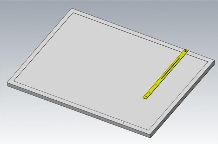
2. Verbinden Sie dann den 60°-Bogen mit dem Solarmodul.
