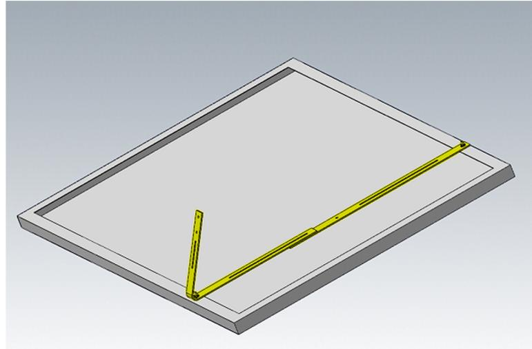
3. Verwenden sie nun die vorgegeben Schraubenlöcher, um die beide Teile in der entsprechenden Position mit dem Solarmodul zu verbinden.
