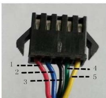
Steckverbinder zum Controller
