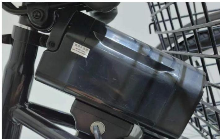
1 Schieben Sie den Akku mit etwas Kraft, seitlich auf die Akkuhalterung des Fahrrads.
