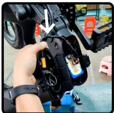
7. Správne položte káble.
