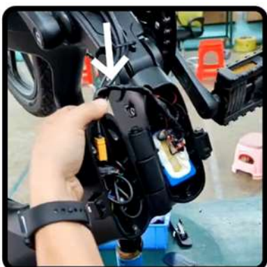
16. Læg kablerne korrekt.
