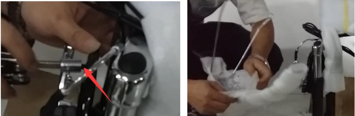
10. Entfernen Sie die Sicherheitsscheibe und setzen Sie das Vorderrad in die Vordergabel. Platzieren Sie den Dichtungsring auf beiden Seiten und ziehen Sie die Schrauben auf beiden Seiten fest.
