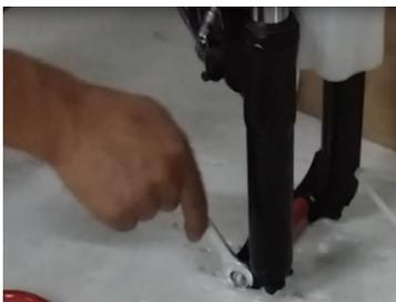
8. Bremscheibe wechseln: Die Schrauben an der Radfelge werden abmontiert (siehe Bild). Die Bremscheibe kann danach abgenommen und eine neue Bremscheibe montiert werden.
