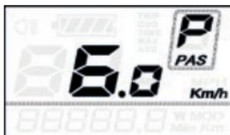
Dieser Modus funktioniert nur, indem die -Taste gedrückt bleibt. Vorsicht! Das E-Bike beschleunigt in diesem Modus.
