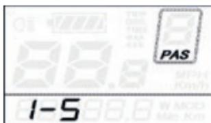
Mit der +/--Taste können Sie zwischen den Modi wechseln. Drücken Sie die Modus-Taste, um die Auswahl zu bestätigen.
