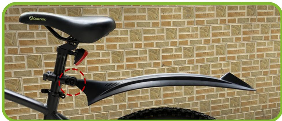
\*Mit der Schraube im roten Kreis kann der Winkel des hinteren Schutzbleches eingestellt werden.
