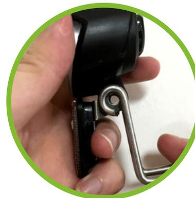
6. Schrauben Sie das Frontlicht an das Schutzblech.
