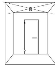
Deckenbefestigung des Fühlers
