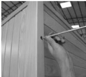
Rückwand (12) mit den Seitenwänden (7)+(10) verbinden.
