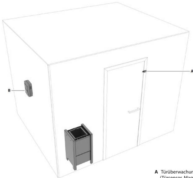
A Türüberwachungseinheit EOSafe D (Türsensor, Magnet)
