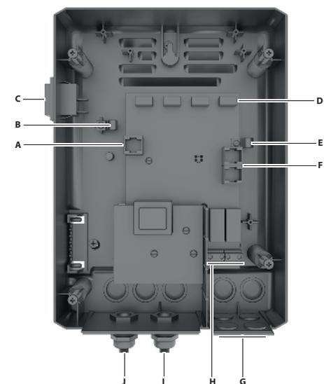
A. Anschluss Türüberwachung
