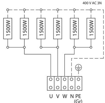
**Achtung!** Beachten Sie unbedingt das Anschlussschema, das im Anschlusskasten des Saunaheizgerätes angebracht ist.
