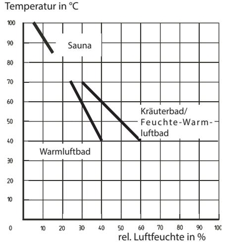
Die im Display angezeigte Feuchteintensität entspricht der zeitproportionalen Verdampfeinstellung. Im Display wird daher nicht die relative Luftfeuchtigkeit vorgewählt bzw. angezeigt, sondern die Einschalthäufigkeit des Verdampfers in Prozent. Die Graphik soll dies verdeutlichen.
