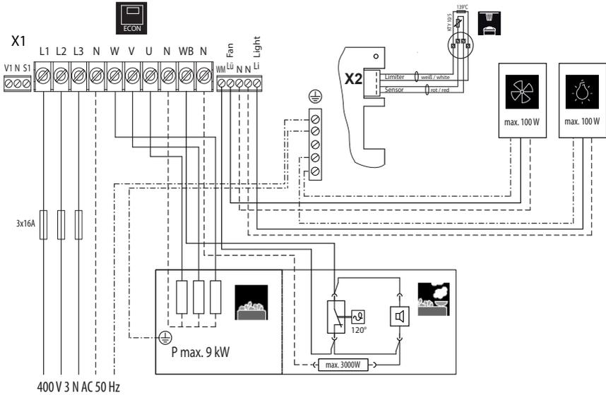
**⚠ Achtung:** Schließen Sie immer den Neutralleiter (N) des Saunaofens an. Bei Feuchtebetrieb wird eine Phase des Saunaofens abgeschaltet, d.h. die Heizlast ist dann nicht symmetrisch. Die Folge ist, dass der Nulleiter dann nicht mehr stromlos ist.
