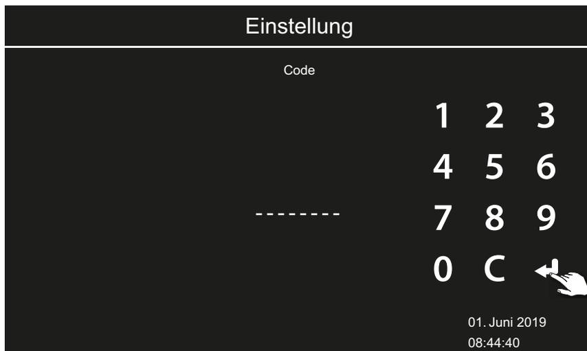
❗ Code **8001**: Induktive Last / ohmsche Last, z. B. bei Verwendung von Glühlampen.
