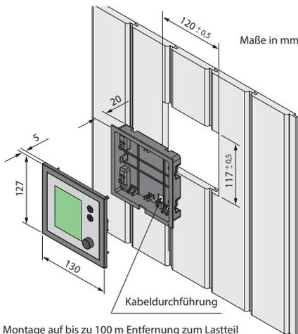
Montage auf bis zu 100 m Entfernung zum Lastteil möglich. Längere Verbindungsleitung erforderlich. 5 m Verbindungsleitung im Lieferumfang enthalten.
