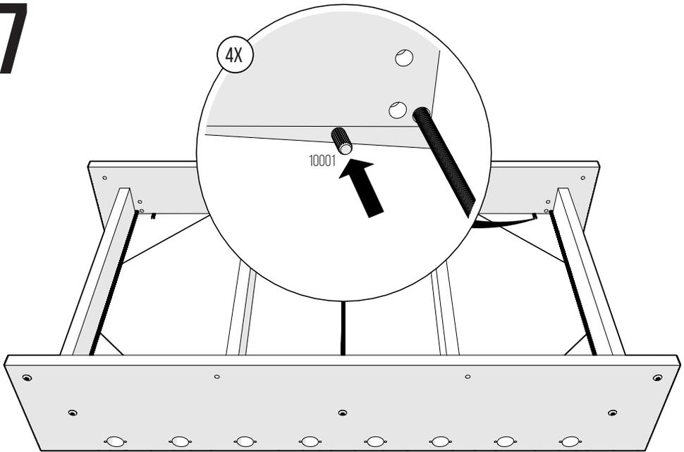
DRÜCKEN SIE DIE 4 ECKEN DES SPIELFELDES NACH UNTEN UND STECKEN SIE NUR MIT DER HAND EINEN DÜBEL ( NR. 1001 ) IN DIE SEITLICHE BOHRUNG. ANSCHLIESSEND DIE SCHRAUBEN ( NR. 10002 ) IM SEITENTEIL FEST ANZIEHEN.
