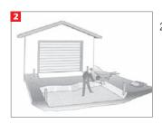
Der Boden wird je nach Belastung der Fläche, z. B. für PKW ca. 20-30 cm tief, ausgehoben. Bei schwer wasserdurchlässigen Böden wie z. B. Ton empfiehlt sich ein Aushub von ca. 40 cm.
