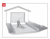
Nach Abbinden der Randbegrenzung wird die Aushubsohle mechanisch verdichtet, z. B. mit einem Rüttler.
