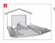
Einbau und Abrütteln der Tragschicht, z. B. bestehend aus Kies/Schotter 2/32-2/45.
